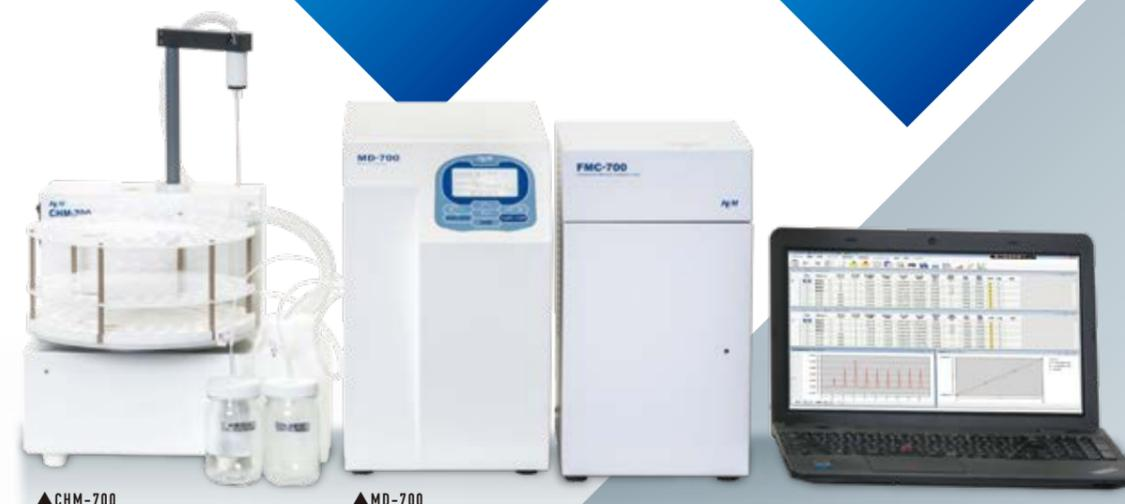
液体、気体試料中の水銀を公定法(標準測定法)に準拠して測定できる水銀専用測定装置です。前処理を施した試料分解溶液を還元容器にセット後、設定した測定条件により還元剤の分注、通気を行い冷蒸気原子吸光法により測定します。また大気試料の測定では水銀捕集管とエアポンプを用いサンプリングを行い、水銀捕集管に捕集された水銀を加熱により離脱させ検出部に導入する、水銀捕集管-加熱気化法により測定します。
