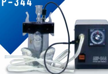
容量滴定方式カールフィッシャー水分計の滴定フラスコを加熱して溶剤中の試料水分を抽出する装置で、チョコレート・キャラメル及び糖類の水分測定に使用します。
