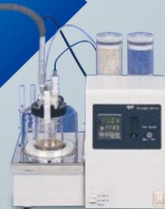
潤滑油、グリース、タール製品、塗料、その他粘性液体の水分測定に使用します。
