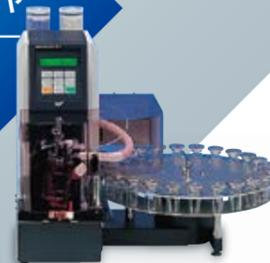
電量滴定方式カールフィッシャー水分計用多検体水分気化装置です。24検体の試料を連続測定できます。検体ごとに加熱温度を設定でき、異なる種類の試料を一度にセットできます。
