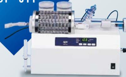
カールフィッシャー水分計の測定フラスコに直接投入できない固体試料を加熱することで水分気化させます。気化した水蒸気を水分計の測定フラスコでバブリングし水分測定をします。
