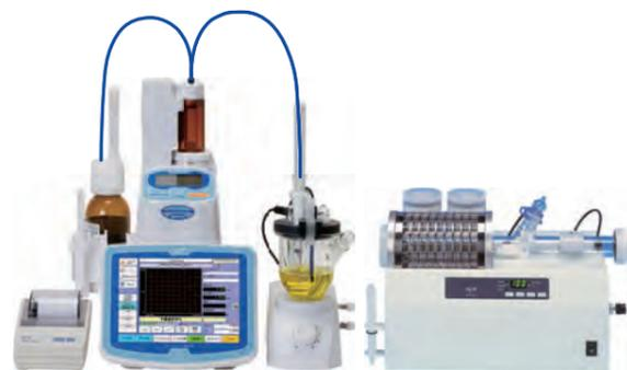
直接滴定では妨害反応を起こしてしまう試料や粉末・固体試料などの水分を測定するための水分気化装置です。試料を加熱し、気化した水蒸気をフラスコ内でバブリングし測定を行います。試料ポートの移動を密閉状態の管外からマグネット方式で行うため、大気中の湿分の影響が少なく、微量水分まで信頼性のある測定が可能です。最適気化温度を自動で算出するスキャンモードの採用により気化温度の設定が容易になりました。加熱管はシンプルな構造になっているため洗浄が容易です。
