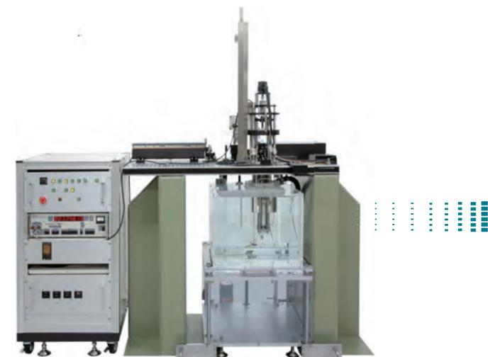
【光干渉式屈折率測定システム】
