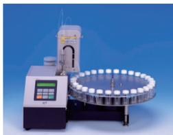
試料を並べて置くだけで、30検体のサンプルを連続で自動測定する密度比重計用のサンプルチェンジャです。サンプリングに圧送方式を採用しているため、高粘度試料にも対応可能です。
